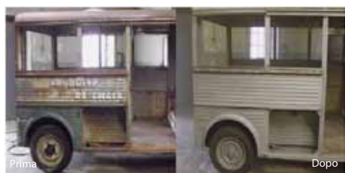
Prima Dopo Rimozione della ruggine e vernice
