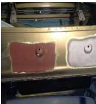
Sverniciatura mezzi d'epoca: a sinistra, solo con ghiaccio secco - a destra, una combinazione di ghiaccio secco e agente abrasivo
